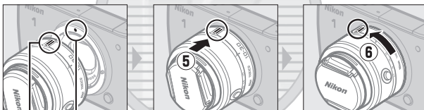
İşaretleri hizalayarak objektifi fotoğraf makinesine takın, ardından yerine oturana kadar döndürün.
