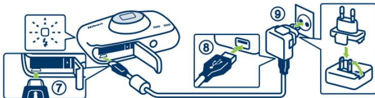
Si se incluye un adaptador de conexión con la cámara, conéctelo a la toma del cargador con adaptador de CA. Empuje el adaptador de conexión firmemente hasta que quede bien encajado. Una vez que ambos estén conectados, si intenta forzar el adaptador de conexión para extraerlo, se podría dañar el producto.
