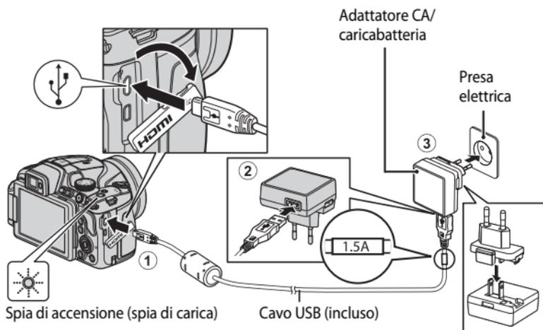
Se un adattatore spina\* è incluso con la fotocamera, collegarlo saldamente all'adattatore CA/caricabatteria. Una volta che i due componenti sono collegati, un tentativo di rimozione forzata dell'adattatore spina potrebbe danneggiare il prodotto.
