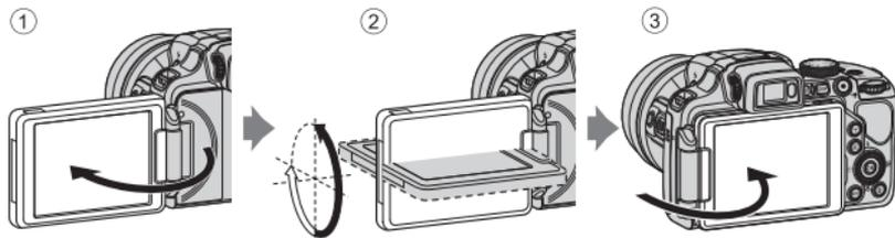
Quando non si sta utilizzando o si sta trasportando la fotocamera, ripiegare il monitor sul corpo macchina con lo schermo rivolto verso l'interno in modo da proteggerlo da graffi o sporcizia.
