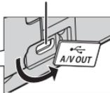
Öffnen Sie die Abdeckung der Anschlüsse.
