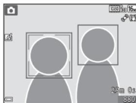
Wenn die Kamera mehr als ein Gesicht erkennt, wird ein Doppelrahmen um das Gesicht angezeigt, auf das die Kamera fokussiert. Die restlichen Gesichter werden mit einem Einfachrahmen versehen.
