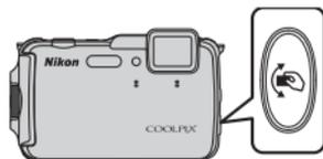
Conforme ilustrado na figura, mexa o pulso para agitar a câmara num único movimento para cima/para baixo ou para a frente/para trás para executar as funções.
