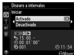
Si el intervalo entre tomas es lo suficientemente grande mientras la cámara está siendo alimentada por una batería, la pantalla se apagará y el indicador de encendido parpadeará entre tomas. Las imágenes no pueden ser reproducidas, sin embargo serán visualizadas automáticamente en la pantalla después de los disparos. Anulación manual (74) no está disponible con autofocus durante el disparo a intervalos; para enfocar manualmente, seleccione el modo de enfoque manual.
