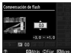
La potencia normal del flash puede restaurarse ajustando la compensación de flash a  $\pm 0$ . La compensación de flash no se restaura al apagar la cámara.
