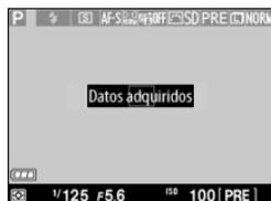
Si la iluminación es demasiado brillante o demasiado oscura, la cámara podría no ser capaz de medir el balance de blancos y se visualizará el mensaje mostrado a la derecha. Vuelva al paso 4 y mida de nuevo el balance de blancos.
