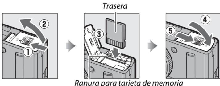
Introducir tarjetas de memoria boca abajo o del revés podría dañar la cámara o la tarjeta. Asegúrese de que la tarjeta esté en la orientación correcta.
