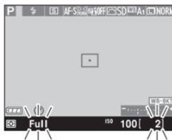
**Horquillado D-Lighting activo:** El primer disparo tras activar el horquillado es realizado con D-Lighting activo desactivado, el segundo en el ajuste actual de D-Lighting activo (☐ 110; si D-Lighting activo está desactivado, el segundo disparo se realizará con D-Lighting activo ajustado a **Automático**).
