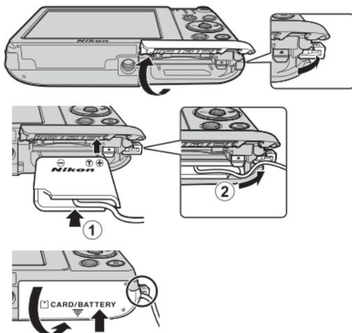
Assicurarsi che il connettore di alimentazione sia inserito completamente nell'apposito alloggiamento prima di inserire l'adattatore CA nel vano batteria. Inoltre, verificare che il cavo del connettore di alimentazione sia inserito completamente nell'alloggiamento del vano batteria prima di chiudere il coperchio del vano batteria/alloggiamento card di memoria. Se una parte del cavo fuoriesce dagli alloggiamenti, quando si chiude il coperchio si potrebbe danneggiare il coperchio o il cavo.
