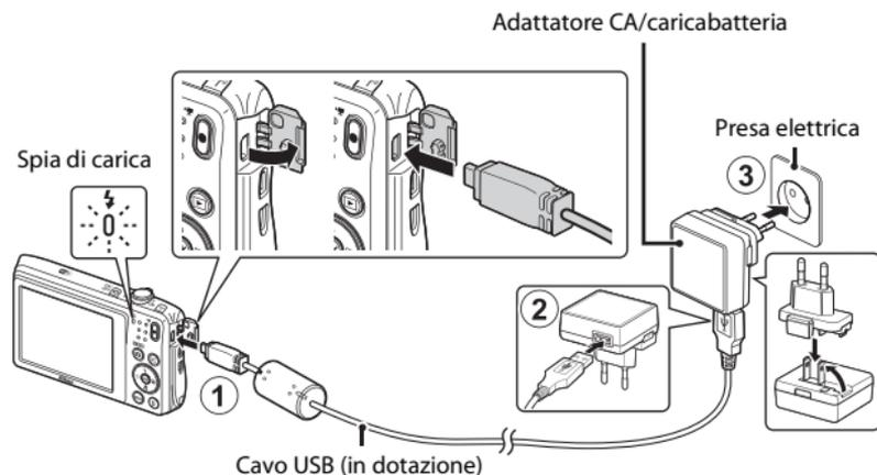
Se la dotazione della fotocamera comprende un adattatore per spina\*, innestarlo saldamente sull'adattatore CA/caricabatteria. Se si tenta di rimuovere con forza l'adattatore per spina una volta che i due componenti sono collegati, si potrebbe danneggiare il prodotto.
