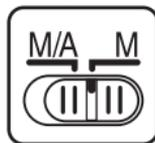
Se a objetiva não estiver equipada com um comutador do modo de focagem, selecione **MF** (focagem manual) para **Modo de focagem** (☞ 74).
