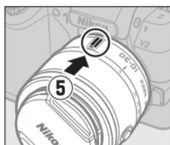
カメラの指標とレンズの指標を合わせてレンズを取り付け、カチッと音がするまで矢印の方向にレンズを回す
