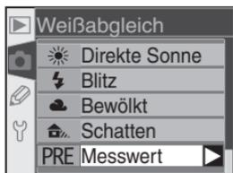
2 Markieren Sie die Option »Messen« und drücken Sie den Multifunktionswähler rechts, um den gespeicherten Messwert als Weißabgleichseinstellung zu aktivieren. Sie kehren anschließend zum Aufnahmemenü zurück.
