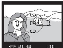
6 Lösen Sie die Kamera aus. Solange Sie den Blitzbelichtungs-Messwertspeicher nicht löschen, können Sie beliebig viele Aufnahmen mit der fixierten Blitzleistung aufnehmen.
