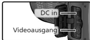
3 Schließen Sie die Kamera wie in der Abbildung gezeigt mit dem EG-D100 an einen Fernseher oder Videorekorder an.
