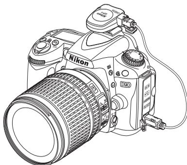
当照相机与 GP-1 建立通讯后，控制面板中将会显示一个 **GPS** 图标。显示 **GPS** 图标时，所拍照片的信息将包含一附加页（第 133 页），以记录当前纬度、经度、海拔以及世界协调时间（UTC）。若在 2 秒内未收到 GP-1 的任何数据，显示的 **GPS** 图标将会消失，且照相机将停止记录 GPS 信息。
