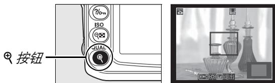
按下 **Q** 可放大（最大至 6.7 倍），按下 **Q**
