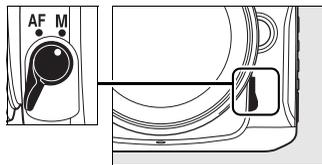
若要手动对焦，请调节镜头对焦环，直至显示在取景器磨砂屏中的图像清晰对焦为止。即使图像未清晰对焦，您也可以随时拍摄照片。
