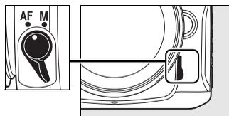
若镜头提供 A-M 选择，使用自动对焦时请选择 **A**。若镜头支持 M/A（手动优先的自动对焦），则选择 **M/A**。若镜头不支持自动对焦或使用自动对焦时照相机无法对焦，请使用手动对焦（第 59 页）。
