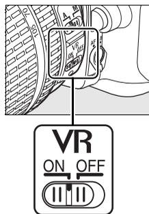
通过将 VR 开关推至 **OFF** 即可关闭减震。当照相机牢固地安置于三脚架上时，请关闭减震，但如果三脚架云台没有固定或使用单脚架时，则需开启减震。
