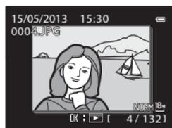
Quando la foto principale di una sequenza è visualizzata nel modo di riproduzione a pieno formato, premere il pulsante **OK** per visualizzare ogni singola immagine di una sequenza. Per tornare alla visualizzazione della sola foto principale, premere **▲** sul multi-selettore.
