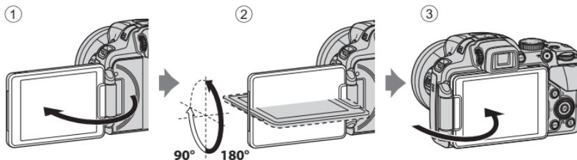
Quando non si sta utilizzando o si sta trasportando la fotocamera, ripiegare il monitor con lo schermo rivolto verso il corpo macchina in modo da proteggerlo da graffi o sporcizia.
