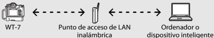
**Modo punto de acceso:** La cámara sirve como un punto de acceso para la conexión directa a un ordenador o dispositivo inteligente.
