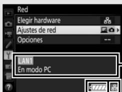
**Nivel de la batería:** El estado de carga de la batería en el WT-7.
