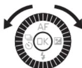
Drehen Sie das hintere Einstellrad nach rechts, um die Mitte des aktuellen Bildes vergrößert darzustellen (☞ 135). Drehen Sie zum Verkleinern nach links. Um mehrere Bilder anzuzeigen, drehen Sie das Wählrad nach links, wenn das Bild als Einzelbild angezeigt wird (☞ 133).
