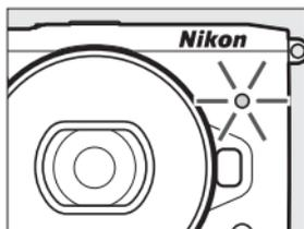
Beachten Sie, dass möglicherweise der Selbstausslöser nicht startet oder das Foto nicht aufgenommen wird, wenn die Kamera nicht scharfstellen kann oder in anderen Situationen, in denen der Verschluss nicht ausgelöst werden kann. Durch Ausschalten der Kamera wird der Selbstausslöserbetrieb abgebrochen.
