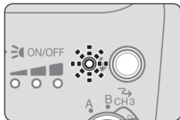
В случае низкой мощности батарей индикатор готовности вспышки будет мигать дважды в сек. непрерывно в течение приблизительно 40 сек. Замените или перезарядите батареи.
