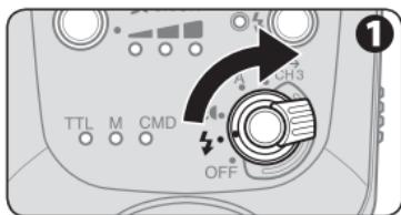
**1 Установите выключатель питания SB-500 в положение [A].**
