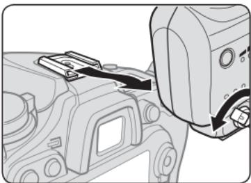
Убедитесь, что вспышка SB-500 и фотокамера выключены, поверните фиксатор ножка крепления на 90° влево, затем выдвиньте ножку крепления SB-500 из башмака для принадлежностей фотокамеры.
