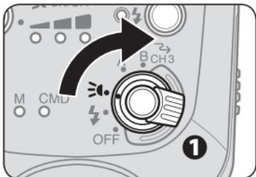
**1 Установите выключатель питания SB-500 в положение [ON].**
