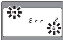
Wenn die SU-800 an Kameras befestigt ist, die nicht mit CLS kompatibel sind, kann die Master-Steuerung nicht verwendet werden. Es wird eine Warnung angezeigt, wenn der Master-Blitzbetrieb ausgewählt ist.
