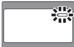
Die Anzeige für eine niedrige Batterieleistung blinkt, wenn die Bereitschaftsanzeige der Blitzfernsteuerungseinheit SU-800 nicht innerhalb von etwa 30 Sekunden nach dem Einschalten des Geräts oder nach dem Auslösen des Blitzgeräts zu blinken beginnt.
