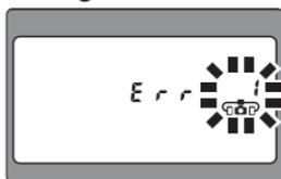
Wenn bei CLS-kompatiblen Kameras die SU-800 über Verbindungskabel an das SB-R200 angeschlossen ist, wird die Meldung »Err« angezeigt und die Anzeige für die Verwendung von Verbindungskabeln blinkt.
