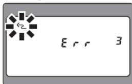
SU-800 kann nicht mit anderen Kameras der COOLPIX-Serie außer COOLPIX P7100, P7000 und P6000 benutzt werden. Wenn es benutzt wird, blinkt die Anzeige für drahtlose Blitzlichtsteuerung zur Warnung.
