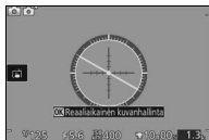
Kameraa kallistettu vasemmalle tai oikealle
