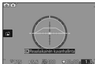
Kameraa kallistettu eteenpäin tai taaksepäin
