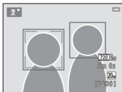
Si l'appareil photo détecte plusieurs visages, le visage sur lequel l'appareil photo a effectué la mise au point est entouré par une double bordure et les autres, par une simple bordure.
