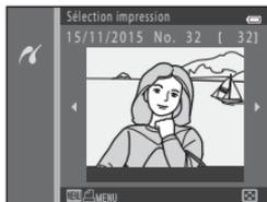
3 Utilisez le sélecteur multidirectionnel ▲▼ pour sélectionner **Format du papier** et appuyez sur la commande **OK**.
