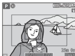
Zusätzlich zu den bei »**Info-Automatik**« angezeigten Informationen wird vor der Aufzeichnung von Filmsequenzen ein Rahmen angezeigt, der dem Bildausschnitt der Filmsequenz entspricht. Die Gitterlinien werden bei der Aufzeichnung von Filmsequenzen nicht angezeigt.
