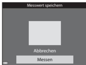
**4** Richten Sie die Kamera so aus, dass sich das weiße oder graue Referenzobjekt im Messfenster befindet, und drücken Sie die OK-Taste, um den Wert zu messen.
