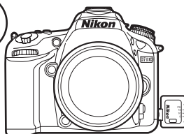
...utløses lukkeren på kameraene som er koblet til WR-R10 (sender-/mottakerenhet).
