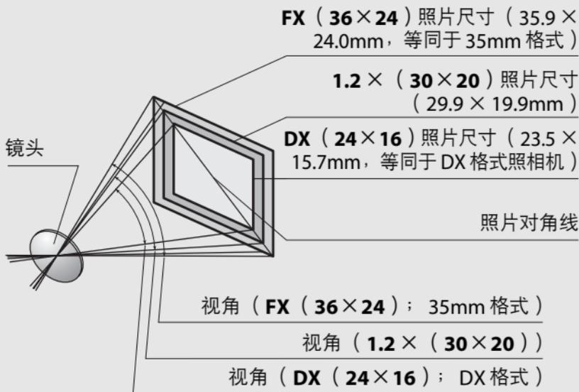
35mm 格式视角约为 **DX (24 × 16)** 视角的 1.5 倍、**1.2 × (30 × 20)** 视角的 1.2 倍。若要计算在 35mm 格式下的镜头焦距, 选择了 **DX (24 × 16)** 时, 请将镜头焦距乘以 1.5, 选择了 **1.2 × (30 × 20)** 时则乘以 1.2 (例如, 选择了 **DX (24 × 16)** 时, 50mm 镜头在 35mm 格式下的有效焦距约为 75mm, 而选择了 **1.2 × (30 × 20)** 时则约为 60mm)。
