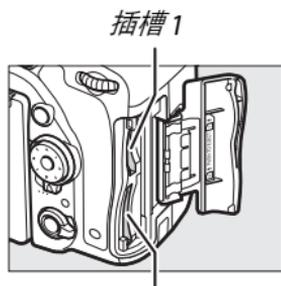
控制面板中将显示当前插有存储卡的插槽（右例所示为两个插槽中均插有卡时显示的图标）。若存储卡已满或已锁定或者发生错误，相应存储卡的图标将会闪烁（☐ 473）。
