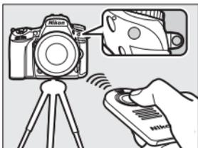
快门释放后自拍指示灯将会闪烁。在遥控弹起反光板模式下，按下 ML-L3 快门释放按钮一次可弹起反光板；30 秒后或再次按下该按钮时，快门将被释放且自拍指示灯将闪烁。
