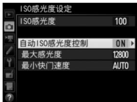
当选择了开启时，取景器和控制面板中将显示**ISO AUTO**。若用户所选的感光度值发生变化，这些指示将闪烁，且变化后的数值将显示在取景器中。
