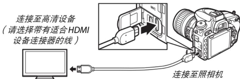
将设备切换至 HDMI 通道，然后开启照相机并按下
