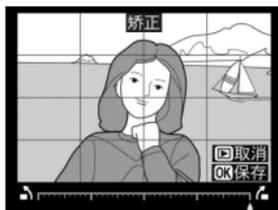
创建已减少周边失真现象的副本。选择自动时，照相机可自动纠正失真，然后您可以使用多重选择器进行微调；选择手动则可手动减少失真现象（请注意，自动不适用于使用自动失真控制拍摄的照片；请参阅第 316 页内容）。按下
