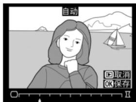
将减少桶形失真，按下则减少枕形失真（您可在编辑显示区内预览效果；请注意，失真控制的量应用得越多，图像边缘就裁切得越多）。按下即可保存照片润饰后的副本。请注意，使用通过 DX 镜头在 DX（24 × 16）以外的影像区域下所拍照片创建副本时，失真控制可能导致副本裁切过量或边缘严重失真。
