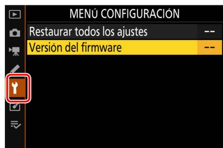
**4** La cámara visualizará las versiones actuales del firmware de la cámara (**C**, **A** o **B**) y de cualquier objetivo (**LF**) o adaptador de montura (**MA**), flash (**S**) o un controlador remoto inalámbrico (**W**) instalados. Confirme que la versión actual del firmware sea la versión correcta para esta actualización.
