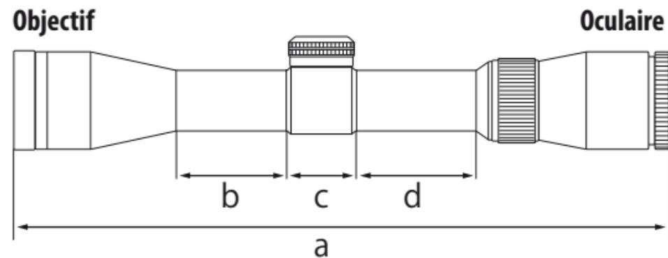
Les lettres a à d du schéma ci-dessus désignent les longueurs (a) à (d) indiquées dans le tableau des caractéristiques.
