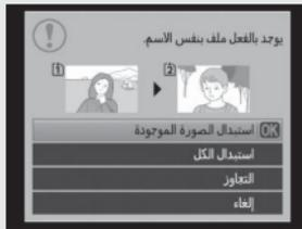
إذا كان المجلد الذي سيتم نسخ الصور إليه يحتوي على صورة بنفس اسم الصورة التي سيتم نسخها. سيتم عرض حوار تأكيد. اختر استبدال الصورة الموجودة لاستبدال الصورة بالصورة التي سيتم نسخها. أو اختر استبدال الكل لاستبدال كل الصور التي لها نفس الأسماء بدون عرض الحوار التأكيدي. للاستمرار بدون استبدال الصورة. اختر التجاوز أو اختر إلغاء للخروج بدون نسخ أي صور إضافية. لن يتم استبدال الملفات المخفية أو المحمية في مجلد الوجهة.
