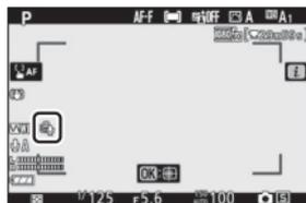
Memilih **Hidup** untuk **Reduksi suara angin** tidak memberi dampak pada mikrofon stereo eksternal. Reduksi suara angin bagi unit yang mendukung fitur ini dapat diaktifkan atau dinonaktifkan menggunakan kontrol mikrofon.
