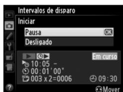
As fotos podem ser reproduzidas e as configurações do disparo e do menu podem ser ajustadas livremente enquanto a fotografia com intervalômetro está em andamento. O monitor desligará automaticamente por mais ou menos quatro segundos antes de cada intervalo.
