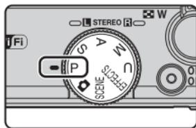
Поворотом диска управления или мультиселектора выберите значение выдержки и диафрагмы.
