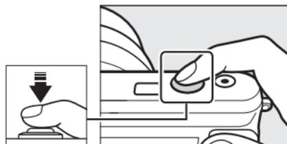
**Si la cámara es capaz de enfocar**, la zona de enfoque seleccionada se iluminará en verde y oírás un pitido (si el sujeto está en movimiento podría no oírse un pitido).
