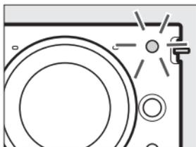
**Fernsteuerungsmodus:** Richten Sie den ML-L3 auf den Infrarot-Sensor an der Kamera (📖 2) und drücken Sie den ML-L3-Auslöser (aus maximal 5 m Abstand). Im Modus »Fernausröser mit Vorlaufzeit« leuchtet die Selbstauslöser-Kontrollleuchte etwa zwei Sekunden lang, bevor der Verschluss ausgelöst wird. Im Modus »Fernausröser« leuchtet die Selbstauslöser-Kontrollleuchte auf, nachdem der Verschluss ausgelöst wurde.
