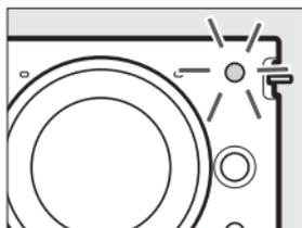
**遙控模式：**將 ML-L3 對準相機上的紅外線接收器 (圖 2)，然後按下 ML-L3 快門釋放按鍵 (站立於 5 m 或更近的距離處)。在延拍遙控模式下，快門釋放前自拍指示燈會點亮約 2 秒。在即拍遙控模式下，快門釋放後自拍指示燈將會閃爍。
