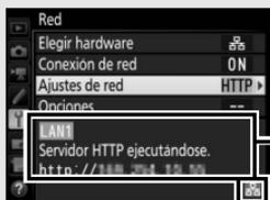
**Zona de estado:** Muestra el estado de la conexión al host. Una vez establecida la conexión, la dirección URL de la cámara aparece visualizada. Aquí también se visualizarán los errores (📄 77).
