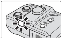
En mode TTL, le témoin de disponibilité rouge du SB-R200 clignote pendant environ 3 secondes après le déclenchement du SB-R200 si l'éclair a été émis à pleine intensité et s'il existe un risque de sous-exposition (les témoins de disponibilité présents sur le SU-800 ou qui apparaissent dans le viseur de l'appareil photo ne clignotent pas).
