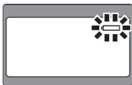
L'indicateur de niveau de pile faible clignote lorsque le témoin de disponibilité du contrôleur SU-800 ne s'allume pas dans les 30 secondes après la mise sous tension ou après le déclenchement du flash.
