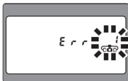
Sur les appareils photo compatibles CLS, si le SU-800 et le SB-R200 sont reliés par des câbles, l'indicateur « Err » apparaît et l'indicateur d'utilisation de câbles clignote.
