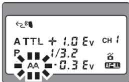
En cas d'utilisation conjointe avec un objectif sans microprocesseur, si le mode de flash est réglé sur flash à ouverture auto (AA), l'indicateur de mode AA clignote pour vous avertir que les flashes de ce groupe ne se déclencheront pas.
