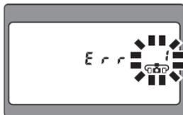
Sur les appareils photo non compatibles CLS, si le SU-800 et le SB-R200 ne sont pas correctement reliés par câbles, l'indicateur d'utilisation de câbles clignote.
