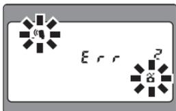
Si le SU-800 est installé sur des appareils photo non compatibles CLS, la fonction Contrôleur ne fonctionne pas. Les indicateurs d'avertissement apparaissent si le mode contrôleur est défini.
