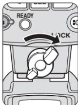
**2** Tournez vers la gauche le levier de verrouillage du sabot de fixation, faites glisser le sabot de fixation du SU-800 dans la griffe flash de l'appareil photo, puis tournez vers la droite le levier de verrouillage.
