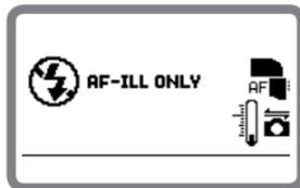
: Die Blitzauslösung wurde am SB-900 ausgeschaltet. Nur das AF-Hilfslicht wird aktiviert.
