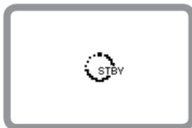
Wenn das SB-900 und die Kamera eine bestimmte Zeit lang nicht bedient werden, wird automatisch der Ruhezustand aktiviert, um Batterie- bzw. Akkuladung zu sparen.
