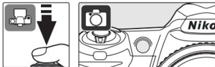
**Fernbedienung:** Richten Sie die Fernbedienung aus einer Entfernung von maximal 5 Metern auf den Infrarotempfänger vorne an der Kamera und drücken Sie den Auslöser an der Fernbedienung. In der Betriebsart »Fernausröser mit Vorlaufzeit« löst die Kamera zwei Sekunden nach Drücken des Auslösers aus.
