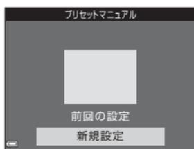
4 測定窓に、用意した白またはグレーの被写体を収め、**OK** ボタンを押して測定する
