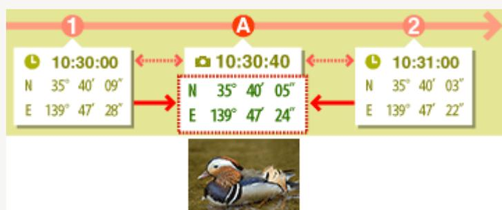
La durée entre les points de trace 1 et 2 est de 1 minute = 60 secondes. L'heure de prise de vue de l'image a 40 secondes de plus que le point de trace 1.
