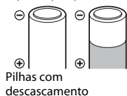
Pilhas cujo isolamento não abranja a área em redor do pólo negativo
