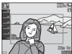
除**自動資訊**中顯示的資訊外，在開始記錄短片之前螢幕上還會顯示一個構圖框，代表記錄短片時將拍攝的區域。
