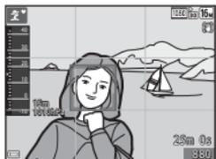
除**自動資訊**中顯示的資訊外，還會顯示構圖網格以幫助構圖。
