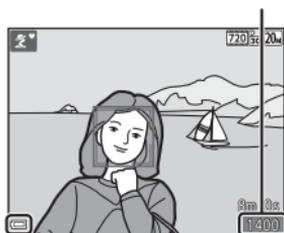
Indicateur du niveau de charge de l'accumulateur
