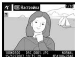
одновременного просмотра на экране шести снимков нажмите кнопку Ⓜ. Чтобы выделить нужные снимки, используйте мультиселектор. Для полнокадрового отображения выделенного снимка нажмите кнопку Ⓞ.
