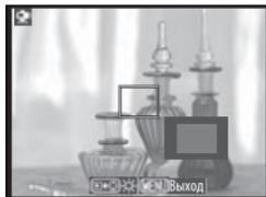
При увеличении изображения, видимого через объектив, в правом нижнем углу монитора отобразится окно навигации. Для просмотра частей кадра, которые не видны на мониторе, можно прокручивать изображение с помощью мультиселектора.
