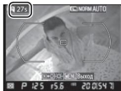
Индикатор обратного отсчета времени отобразится на мониторе за 30 с до прекращения съемки. При высокой окружающей температуре этот индикатор может отобразиться сразу после выбора режима Live view.
