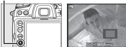
При увеличении изображения, видимого через объектив, в правом нижнем углу монитора отобразится окно навигации. С помощью мультиселектора можно прокручивать изображение в пределах границ зоны АФ.
