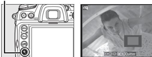
Lorsque vous effectuez un zoom avant sur la vue de l'objectif, une fenêtre de navigation apparaît dans le coin inférieur droit de l'affichage. Utilisez le sélecteur multidirectionnel pour déplacer cette fenêtre dans la délimitation de la zone AF.
