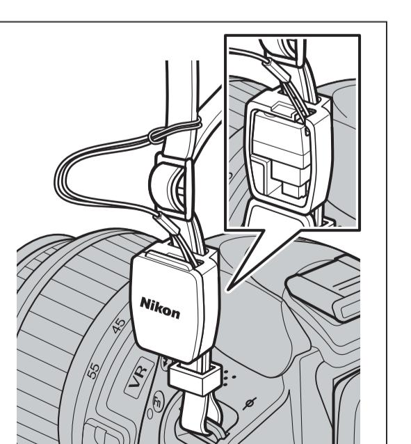
图 2：吊带和适配器套的安装方法示例 /
