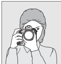
Wenn Sie im Hochformat fotografieren möchten, lösen Sie den Sperrschalter des Hochformatauslösers (Seite 5) und halten Sie die Kamera wie rechts abgebildet.
