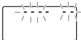
nach oben in die Wartungsposition. Der Verschlussvorhang öffnet sich und gibt den Bildsensor mit dem Tiefpassfilter frei. Bei hochgeklapptem Spiegel ist der Sucher schwarz. Die Striche auf dem oberen Display blinken.
