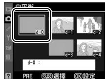
若要使用新的白平衡值，請選擇預設 d-0（在選擇 d-0 前若未測量白平衡值，白平衡將設為色溫 5,200 K，與 **直射陽光** 相同）。新的白平衡值將保留在預設 d-0 中，直到重新測量白平衡。測量白平衡新值前透過複製預設 d-0 到任一其他預設中，最多可儲存 5 個白平衡值（第 104 頁）。
