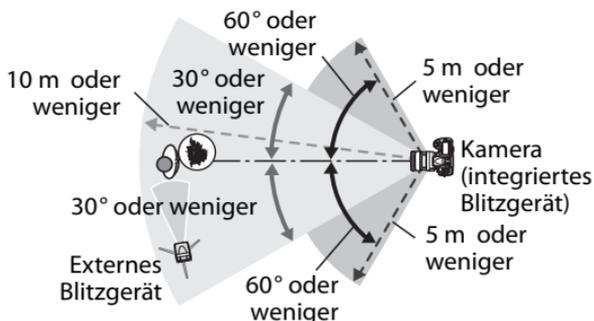
Die Lichtsensoren, die die Signale des Master-Blitzgeräts empfangen, sollten zur Kamera gerichtet sein.
