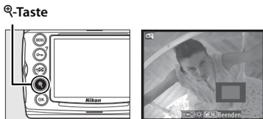
Während ein Bildausschnitt vergrößert angezeigt wird, wird ein Navigationsfenster in der rechten unteren Ecke des Monitors eingeblendet. Verwenden Sie den Multifunktionswähler, um im AF-Messfeldbereich zu navigieren.
