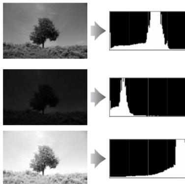
Bei einer Belichtungskorrektur zu einer Überbelichtung hin wird die Tonwertverteilung nach rechts verschoben, bei einer Belichtungskorrektur zu einer Unterbelichtung hin wird sie nach links verschoben. Ein Histogramm kann Ihnen eine ungefähre Vorstellung von der Belichtung eines Fotos vermitteln, besonders wenn helles Umgebungslicht eine Beurteilung des Fotos auf dem Monitor nicht zulässt.
