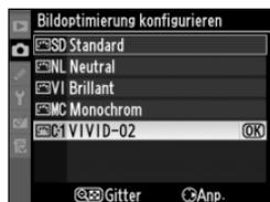
Der Name einer benutzerdefinierten Konfiguration kann jederzeit mit der Funktion »**Umbenennen**« aus dem Menü »**Konfigurationen verwalten**« geändert werden.
