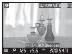
Livebild angezeigt. Das Motiv kann nun nicht mehr durch den Sucher betrachtet werden. Um den Live-View-Betrieb zu verlassen, ohne ein Bild aufzunehmen, drehen Sie den Aufnahmebetriebsartenwähler in eine andere Position oder drücken Sie die **MENU-Taste**.
