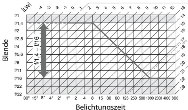
Die Grenzwerte des Belichtungsumfangs hängen von der eingestellten ISO-Empfindlichkeit ab. Das Diagramm bezieht sich auf eine Empfindlichkeit von ISO 200. Bei der Matrixmessung belichtet die Kamera alle Aufnahmen, deren Lichtwert  $17^{1/3}$  LW übersteigt, mit  $17^{1/3}$  LW.
