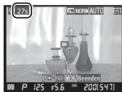
Schließen Sie den Sucherokularverschluss nach dem Scharfstellen. Dadurch wird verhindert, dass Streulicht durch den Sucher einfällt und zu einer Fehlbelichtung führt.
