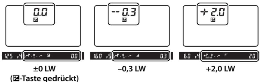
Die Belichtungskorrektur kann im Bereich zwischen  $-5$  LW (Unterbelichtung) und  $+5$  LW (Überbelichtung) in Schritten von  $\frac{1}{3}$  LW eingestellt werden. Als Faustregel kann gelten: Stellen Sie einen positiven Korrekturwert ein, wenn das Motiv dunkler als der Hintergrund ist, und einen negativen Wert, wenn das Motiv heller als der Hintergrund ist.
