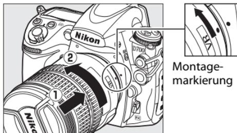
Wählen Sie bei Objektiven mit »A-M«-Umschalter die Einstellung »A« (Autofokus) und bei Objektiven mit »M/A-M«-Umschalter die Einstellung »M/A« (Autofokus mit manueller Scharfeinstellung).
