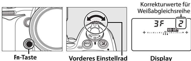
Es stehen die Korrekturwerte 1 (5 Mired), 2 (10 Mired) und 3 (15 Mired) zur Auswahl. Folgt einem Korrekturwert ein **B**, werden die Bildfarben zu Blau hin verschoben (kühlere Anmutung), folgt ihm ein **A**, werden die Farben zu Gelborange hin verschoben (wärmere Anmutung) (Seite 144). Im Folgenden sind Belichtungsreihenprogramme mit einer Schrittweite von 1 LW aufgeführt.
