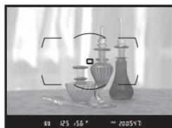
ein Fokussmessfeld mit dem Multifunktionswähler und drücken Sie die **AF-ON-Taste**. Die Kamera stellt auf übliche Weise Schärfe und Belichtung ein. *Beachten Sie, dass durch Drücken des Auslösers bis zum ersten Druckpunkt nicht scharf gestellt werden kann.*
