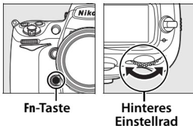
Sie können die aktuelle Bildfeldeinstellung anzeigen, indem Sie die **Fn**-Taste drücken, um das Bildfeld im Sucher, auf dem Display oder in der Anzeige der Aufnahmeinformationen anzuzeigen. Das FX-Format wird als »36 – 24«, das DX-Format als »24 – 16« angezeigt.
