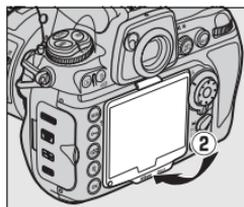
Um die Abdeckung wieder zu entfernen, halten Sie mit einer Hand die Kamera und ziehen Sie mit der anderen vorsichtig die Abdeckung vom Monitor weg (siehe Abbildung rechts).
