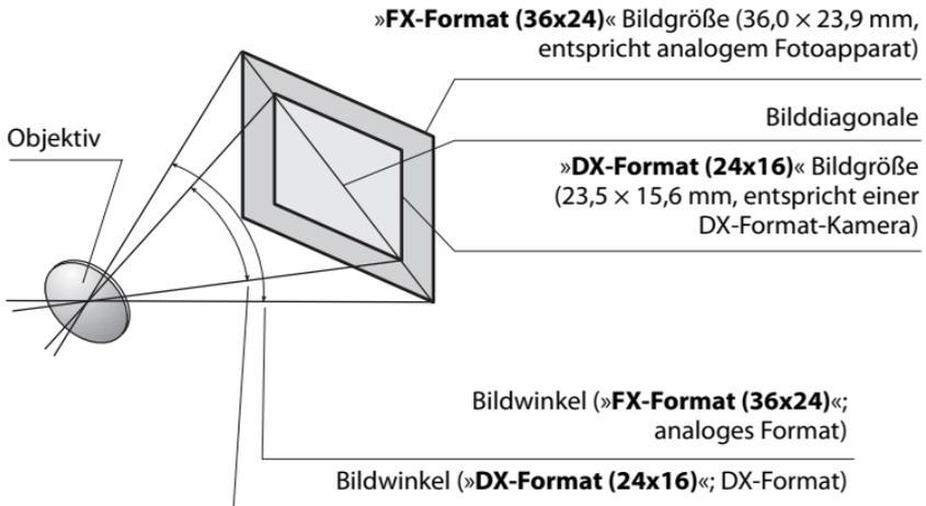
Der Bildwinkel für das »**DX-Format (24x16)**« ist ca. 1,5 Mal so klein wie der Bildwinkel einer analogen Kamera. Die ungefähre Brennweite von Objektiven im analogen Format für den Fall, dass das »**DX-Format (24x16)**« ausgewählt wurde, wird folgendermaßen berechnet: Multiplizieren Sie die Brennweite des Objektivs mit 1,5. (Beispiel: Die effektive Brennweite eines 50-mm-Objektivs für analoge Kameras entspricht 75 mm, wenn »**DX-Format (24x16)**« ausgewählt wurde).
