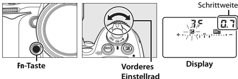
Standardmäßig kann als Schrittweite  $\frac{1}{3}$ ,  $\frac{2}{3}$  oder 1 LW ausgewählt werden. Im Folgenden sind Belichtungsreihenprogramme mit einer Schrittweite von  $\frac{1}{3}$  LW aufgeführt.
