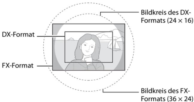
Das Bildfeld kann mit der Option »**Bildfeld**« im Aufnahmemenü oder (wenn der **Fn**-Taste ein Bildfeld zugewiesen wurde) mit der **Fn**-Taste und durch Drehen des hinteren Einstellrads eingestellt werden.
