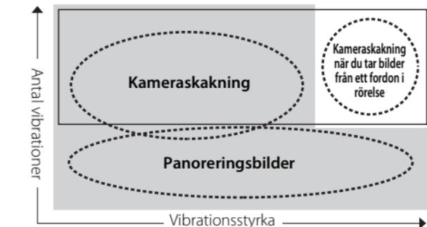
Ställ in lägesbrytaren för vibrationsreducering på **NORMAL**.
