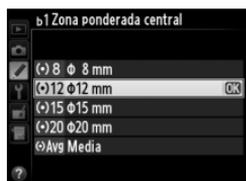
Tenga en cuenta que el diámetro será fijado a 12 mm al utilizarse un objetivo sin CPU, sin importar el ajuste seleccionado para **Datos objetivos sin CPU** en el menú configuración (📖 163).
