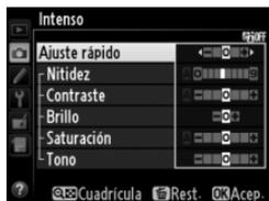
**Ajuste rápido** para elegir una combinación de ajustes predeterminada. Los ajustes predeterminados pueden restablecerse pulsando el botón 🗑️.
