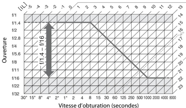
Les valeurs maximales et minimales de l'incrément d'exposition varient en fonction de la sensibilité ; le graphique ci-dessus se base sur une sensibilité équivalente à 100 ISO. En cas d'utilisation de la mesure matricielle, les valeurs supérieures à  $16^{1/3}$  IL sont réduites à  $16^{1/3}$  IL.
