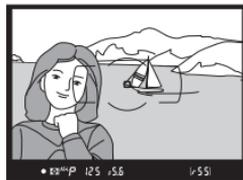
Ne modifiez pas la distance entre l'appareil photo et le sujet pendant la mémorisation de la mise au point. Si le sujet se déplace, effectuez à nouveau la mise au point pour prendre en compte la nouvelle distance.
