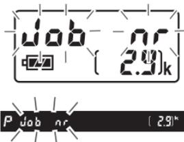
la place de la vitesse d'obturation/ouverture et il est impossible de prendre des photos (si vous mettez l'appareil photo hors tension avant que le traitement ne soit terminé, la photo est enregistrée, mais la réduction du bruit n'est pas effectuée). En mode de déclenchement continu, la cadence de prise de vue ralentit et, pendant le traitement des photos, la capacité de la mémoire tampon diminue.
