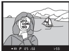
Vous pouvez sélectionner le mode de zone AF en appuyant sur la commande de mode AF et en tournant la molette de commande secondaire jusqu'à l'apparition du réglage souhaité dans le viseur.
