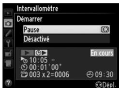
Vous pouvez visualiser les photos et ajuster librement les réglages de prise de vue et de menu lorsque la prise de vue en mode intervallo-mètre est en cours. Le moniteur s'éteint automatiquement environ quatre secondes avant chaque intervalle.
