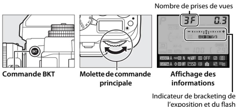
Avec les réglages autres que **3F**, l'icône **BKT** est affichée sur l'écran de contrôle. **BKT** apparaît dans le viseur, tandis qu'un indicateur de bracketing et une icône correspondant au type de bracketing activé sont visibles sur l'affichage des informations : **AE-BKT** (bracketing de l'exposition et du flash), **AE-BKT** (bracketing de l'exposition uniquement) ou **3-BKT** (bracketing du flash uniquement).
