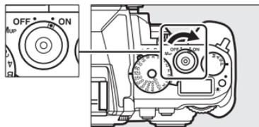
Faites pivoter le commutateur marche-arrêt comme indiqué pour mettre l'appareil photo hors tension.
