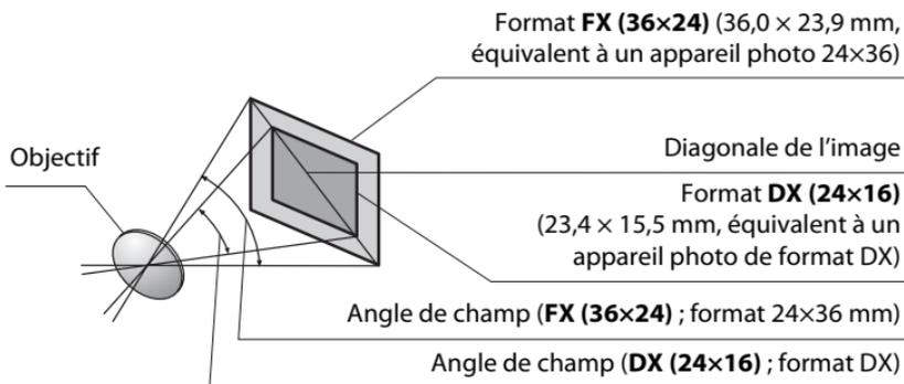
L'angle de champ **DX (24×16)** est environ 1,5 fois plus petit que l'angle de champ du format 24×36. Pour calculer la focale des objectifs 24×36 lorsque **DX (24×16)** est sélectionné, multipliez la focale de l'objectif par environ 1,5 (par exemple, la focale effective d'un objectif de 50 mm au format 24×36 est d'environ 75 mm lorsque **DX (24×16)** est sélectionné).
