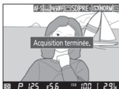
Si l'appareil photo ne parvient pas à mesurer la balance des blancs, le message ci-contre s'affichera. Choisissez une nouvelle cible de balance des blancs et répétez la procédure à partir de l'étape 4.
