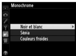
Il est possible d'afficher un aperçu de l'image en sélectionnant l'option **Sépia** ou **Couleurs froides** ; appuyez alors sur ▲ pour augmenter la saturation des couleurs, et sur ▼ pour la diminuer. Appuyez sur
