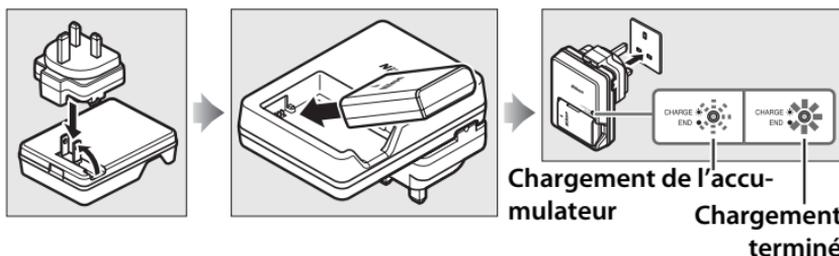
Environ une heure et 50 minutes sont nécessaires pour recharger complètement l'accumulateur lorsque celui-ci est entièrement déchargé. Débranchez le chargeur et retirez l'accumulateur une fois le chargement terminé.
