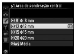
Note que o diâmetro será fixado em 12 mm quando uma lente sem CPU for usada, independentemente da configuração selecionada para **Dados da lente sem CPU** no menu de configuração (☞ 163).
